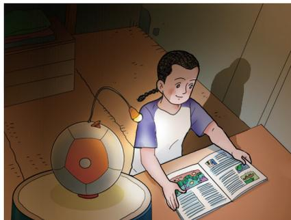
미국의 한 기업은 전기 에너지의 혜택을 받지 못하는 아이들을 위해 자가 발전 축구공을 개발하였다. 축구공 안에 진동을 감지하는 장치와 하이브리드형 발전기가 내장되어 있어, 아이들이 공을 가지고 노는 동안 내부 배터리에 전기가 충전되어 에너지를 생산한다. 축구공을 30분 정도를 가지고 놀면 약 3시간 가량 LED 조명을 밝힐 수 있다. 이러한 기술 혁신과 기업가 정신을 통해 전기가 들어오지 않는 아프리카의 아이들은 밤에도 책을 읽을 수 있게 되었다.
